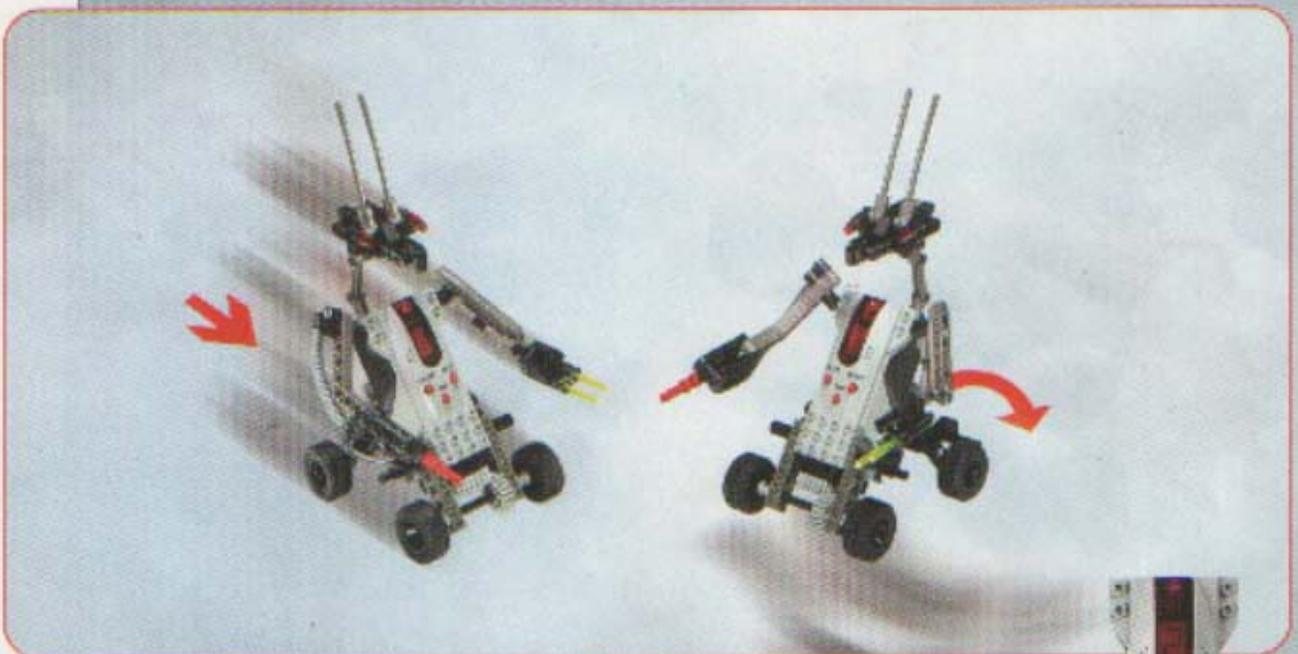
Mit Select (Auswahl) und Run (Start) führst du Programm 2 (Zwei Richtungen) aus. L-8GO fährt vorwärts und dreht dabei drei Mal um.
