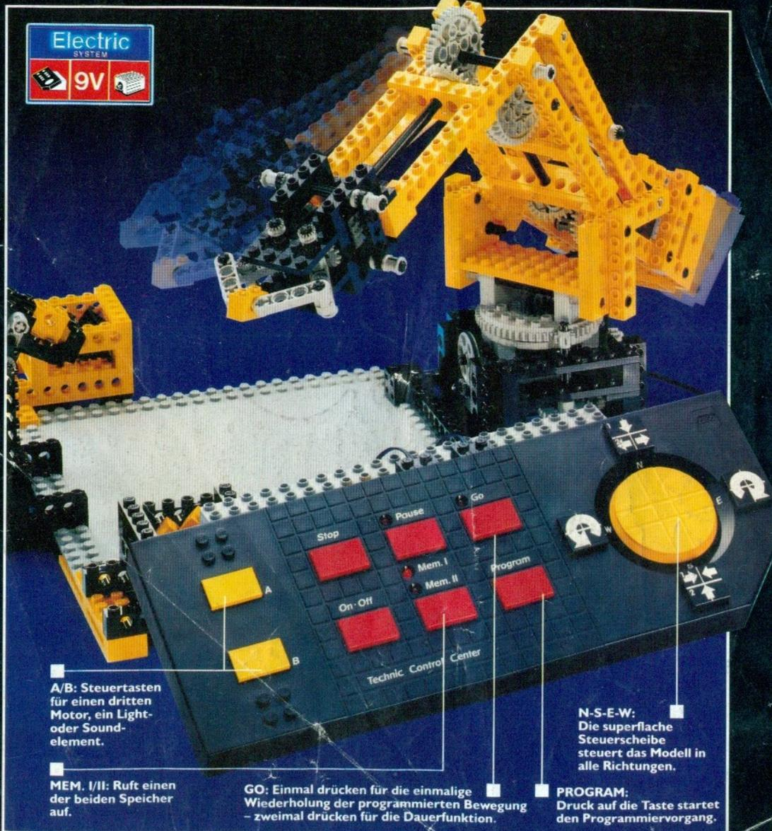
**A/B:** Steuertasten für einen dritten Motor, ein Light- oder Soundelement.
